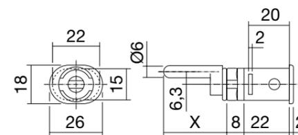
mit ovalem Gehäuse 15 x 22 mm für Wechselzylinder VCS18 Metallguss vernickelt VPE 50
