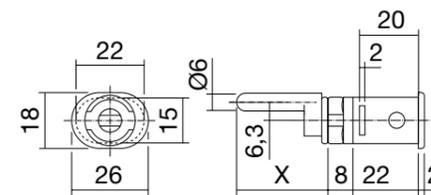
mit ovalem Gehäuse 15 x 22 mm für Wechselzylinder VCS18 zum Clipsen Metallguss matt vernickelt VPE 50
