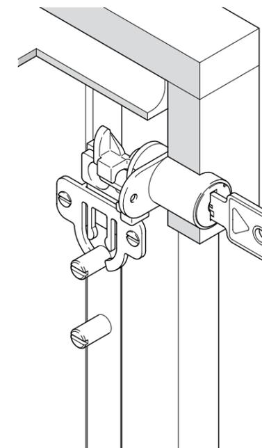
Zentralverschlussstange Typ 0922 C-Profil 15,8 x 3 mm
