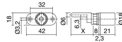
für Wechselzylinder VCS18 zum Aufschrauben Metallguss matt vernickelt VPE 50
